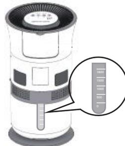
※使用中に水を補填するには、本体上部の背面にある給水ポケットを開き、ピープ音が鳴るまで水を入れます。この時電源が入ってなかったり、水位感知センサーの汚れなどによる誤作動が起きる場合はピープ音が鳴らず、水槽の水があふれることがあります。水の補填時は必ず水槽の水があふれないかを確認し、あふれる時には水槽の水を指定線まで捨てて、床などにあふれた水はすぐ拭き取ってください。
